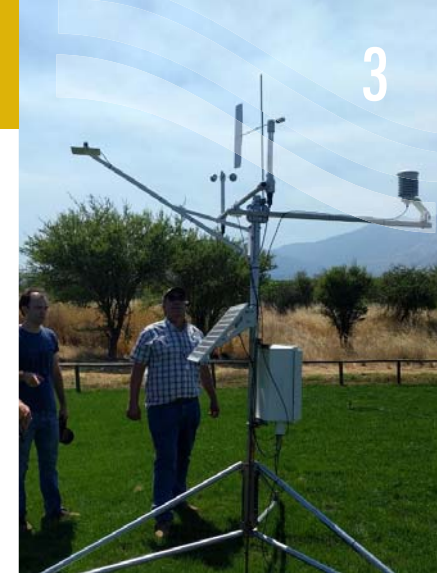
Estación de evapotranspiración de referencia.
